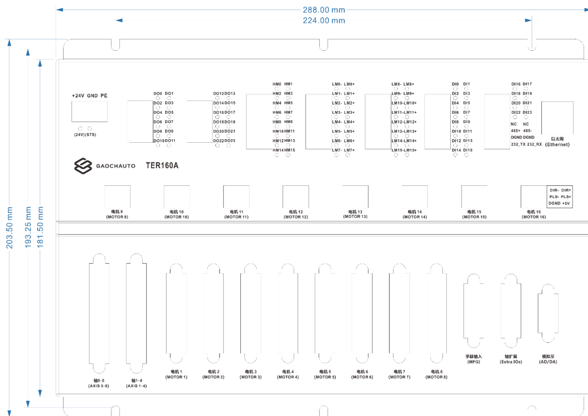
图 1.2.2 GCS160A-PCIE 控制卡端子板尺寸图
