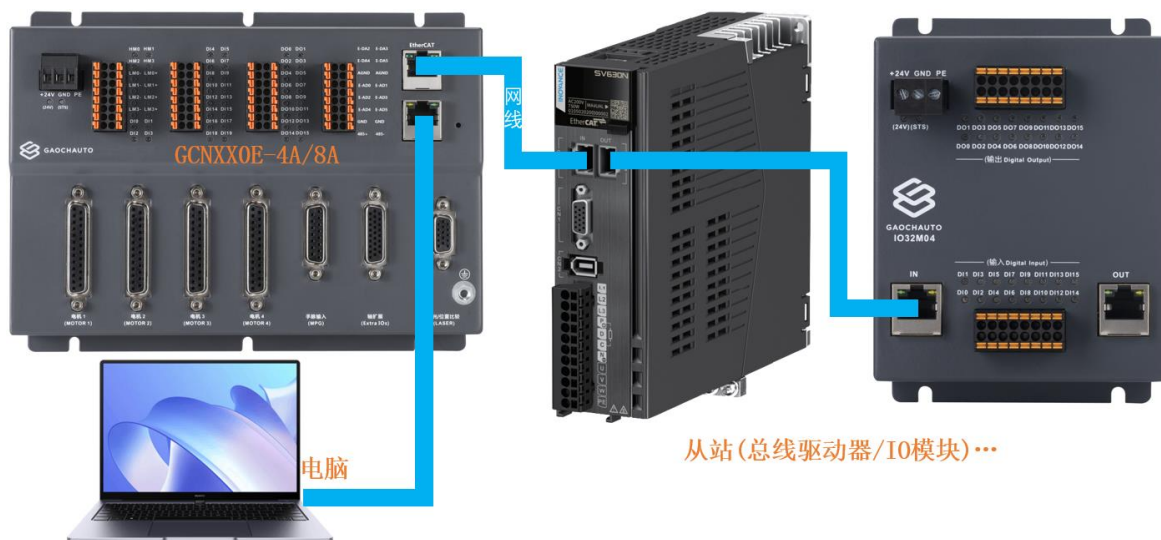
1.2.1 GCNXX0E-4A/8A 网络控制器接线图
